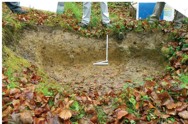
Abb. 2: Das Bodenprofil zeigt einen Spurtyp 3.
